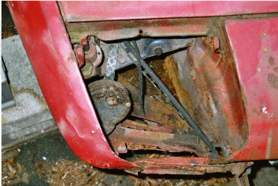
Scheinwerferschacht bei ausgebautem Schlaufauge
