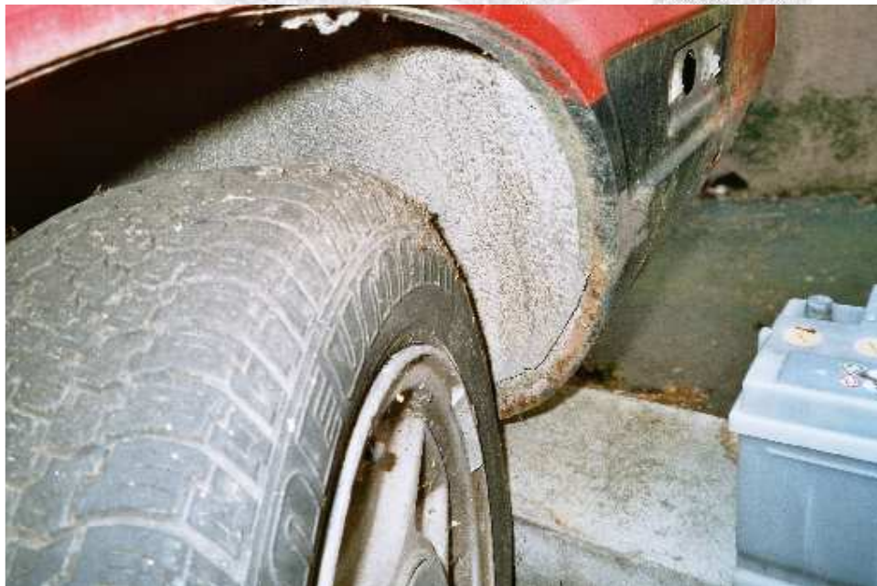
vorderes Radhaus mit Innenkotflügel und Rost am Kotflügelansatz unten
